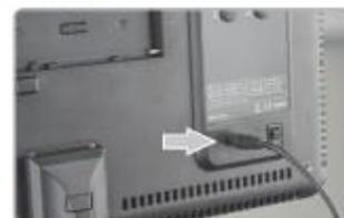
Energia DC: O Video Light pode ser usado com energia DC. Use o adaptador 13-16.8V (incluso), para conectar à entrada DC do video light.
