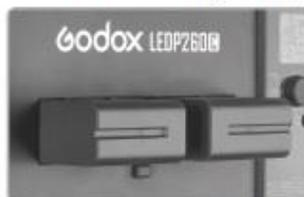
Bateria de Lítio: Com duas baterias de Lítio tipo Sony NP-F970 (vendida separadamente) encaixe ambas no compartimento de baterias
