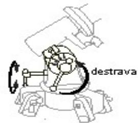
Após algum tempo você notará o objeto observado saindo do campo de visão. Para mantê-lo a vista centralizado, gire o cabo R.A. Após o alinhamento polar, não serão mais necessários ajustes azimutais e de latitude, e o tripé não deverá também ser movimentado, os únicos movimentos deverão ser através dos eixos "ajuste fino R.A." e "ajuste fino DEC", afim de manter o objeto dentro do campo de visão conforme instruções no item nº8 acima.
